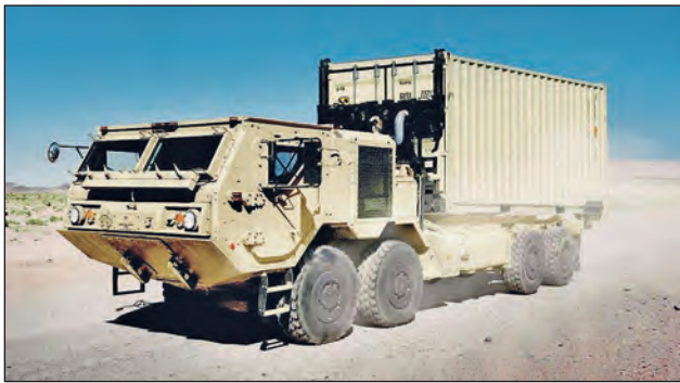
7. ábra. A jól bevált Oshkosh HEMTT már villamos hajtással is elérhető (TruckTrend)
